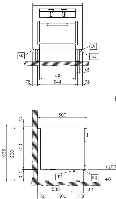
**EI** = Conexión eléctrica (energía)
